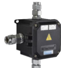
Verbindungskasten aus GRP mit Kabelverschraubungen aus vernickeltem Messing mit doppelter Klemmung, Verschlusskappe und Klemmen laut Beschreibung.
